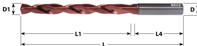
Максимальная глубина обработки  $t_{max} = L1 - 1,5 \times D1$
